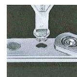
Cheie speciala care permite demontarea limitatorului
